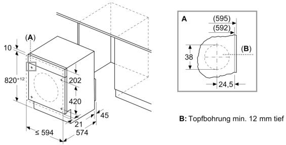
B: Topbohrung min. 12 mm tief
