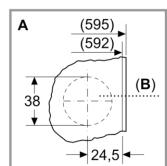
B: Topbohrung min. 12 mm tief
