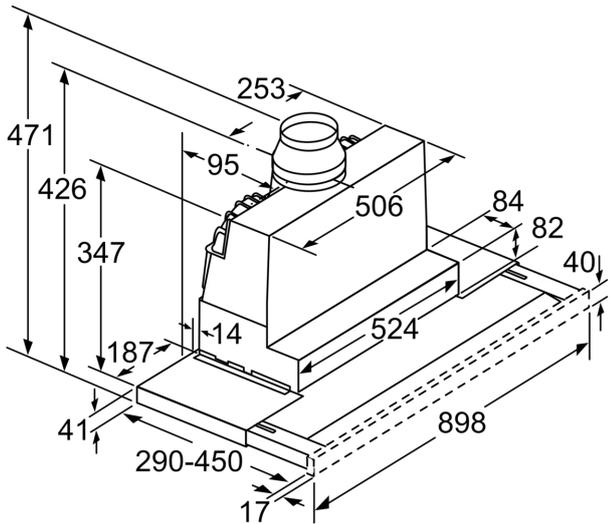
Tiefenanpassung des Filterauszuges bis 29 mm möglich
