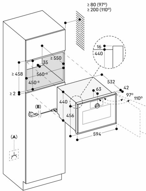
**A:** Frei zugänglicher elektrischer Anschluss
