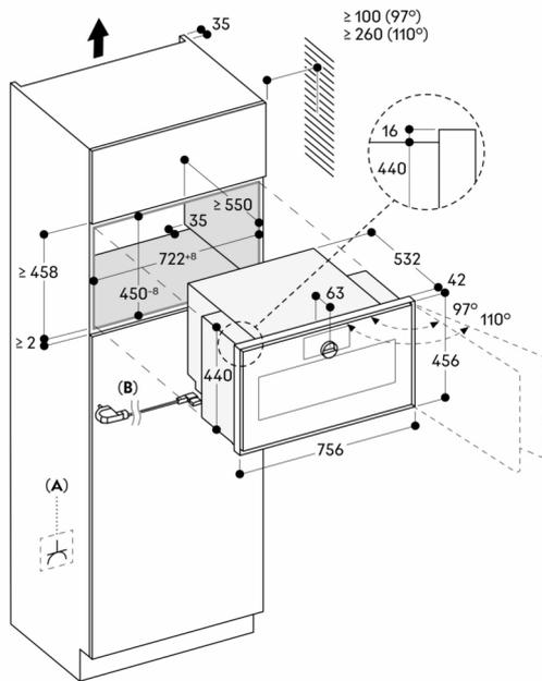
**A:** Frei zugänglicher elektrischer Anschluss
