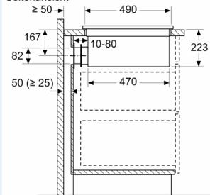
Bei der Installation direkt an einer nicht isolierten Außenwand ( $\mu \geq 0,5 \text{ W/m}^2\text{°C}$ ) empfehlen wir die Verwendung von Konfigurationen mit teilweise oder vollständig kanalisierter Rezirkulation.
