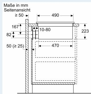
Bei der Installation direkt an einer nicht isolierten Außenwand ( $\lambda \geq 0.5 \text{ W/m}^2 \text{ °C}$ ) empfehlen wir die Verwendung von Konfigurationen mit teilweise oder vollständig kanalisierte Rezirkulation.
