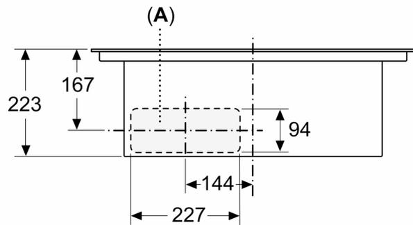
A: Direkt an der Rückseite angeschlossen
