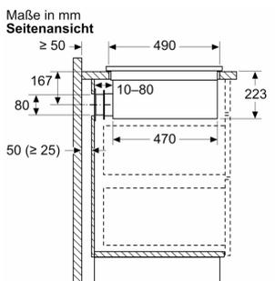
Nicht empfohlen für nicht wärmeisolierte Außenwände oder Böden ( $U \geq 0,5 \text{ W/m}^2\text{K}$ )
