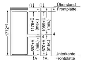
Die angegebenen Möbeltürmaße gelten für eine Türfuge von 4 mm. Bei Verwendung einer anderen Fugenbreite (max. 14 mm) müssen die Maße angepaßt werden.
