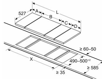
Bei Einbau von zwei oder mehr Elementen nebeneinander sind ein oder mehrere Montagesätze erforderlich (2 Elemente = 1 Montagesatz, 3 Elemente = 2 Montagesätze usw.)
