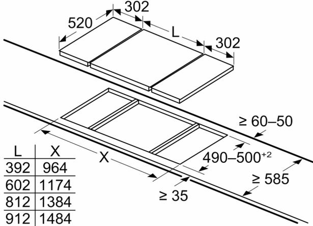
Bei Einbau von zwei Domino-Elementen direkt neben einer Mulde sind zwei Montagesätze (HZ394301) erforderlich
