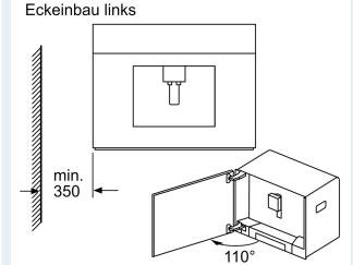
Bei Verwendung der 92° Scharnierbegrenzung (Ersatzteilnr. 00636455) beträgt der Mindestabstand zur Wand nur 100 mm. Masse in mm
