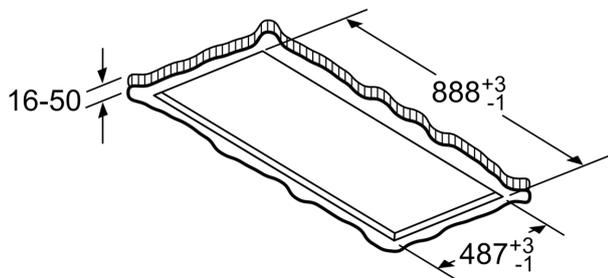
Nicht direkt in die Gipskartonplatte oder ähnliche Leichtbaustoffe der abgehängten Decke montieren. Geeignetes Untergerüst erforderlich, das fest in der Betondecke fixiert ist.
