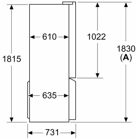
**A:** Front ist von 1830–1847 mm, bei voll ausgezogenen vorderen Nivellierfüßen, verstellbar
