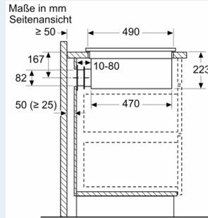
Bei der Installation direkt an einer nicht isolierten Außenwand ( $\mu \geq 0.5 \text{ W/m}^2\text{°C}$ ) empfehlen wir die Verwendung von Konfigurationen mit teilweise oder vollständig kanalisierter Rezirkulation.
