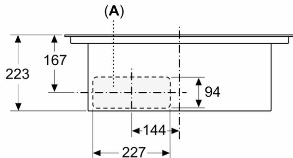
A: Direkt an der Rückseite angeschlossen
