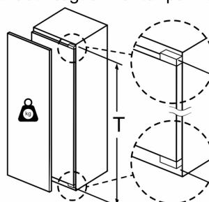
Monterede låger, som overskider den tilladte vægt, kan medføre beskadigelser og reduceret funktion af hængslerne.
