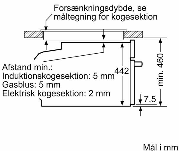
Hvis det kompakte apparat bygges ind under en kogesektion, skal følgende bordpladetykkelse (i givet fald inkl. underkonstruktion) overholdes.
