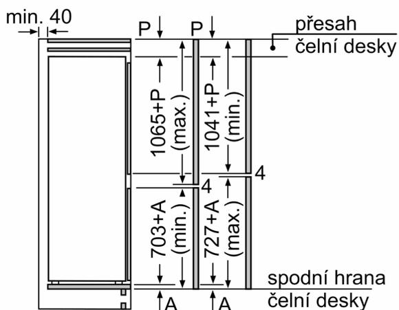
Uvedené rozměry dveří platí pro polodrážku dveří 4 mm.
