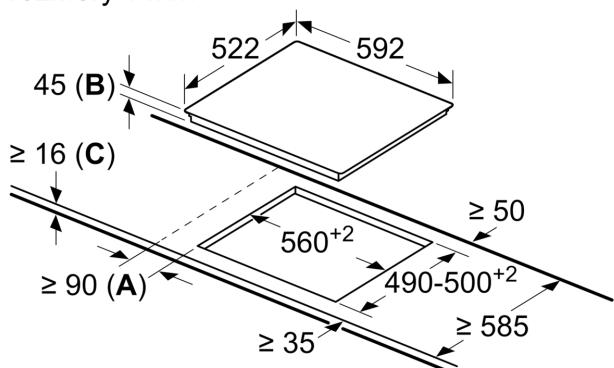
**A:** Minimální vzdálenost od výřezu ke stěně.
