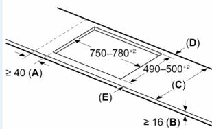
A: Min. vzdálenost od výřezu varného panelu ke stěně
