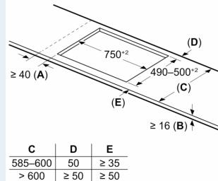
A: Min. vzdálenost od výřezu varného panelu ke stěně
