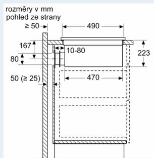
Při instalaci přímo proti vnějším stěnám, které nejsou izolované ( $\mu \geq 0,5 \text{ W/m}^2\text{C}$ ) doporučujeme použít částečně nebo plně kanálové konfigurace recirkulace.
