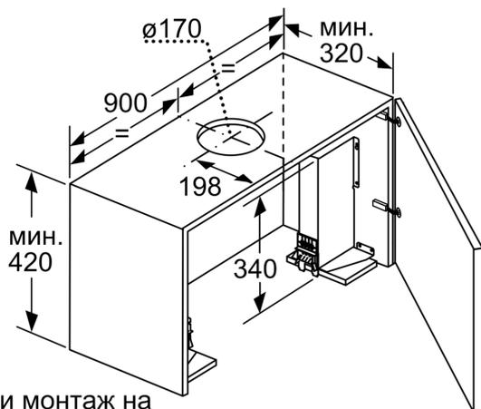
При монтаж на 90см плосък капак в 90см широк шкаф на стена е нужен монтажен комплект. Двата монтажни винкела се завинтват отдясно и отляво в кухненския уред. Монтаж по шаблон. Измерване в мм
