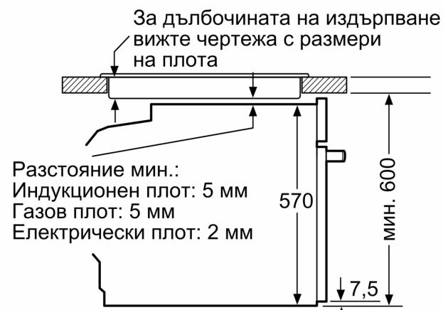
измерване в мм
