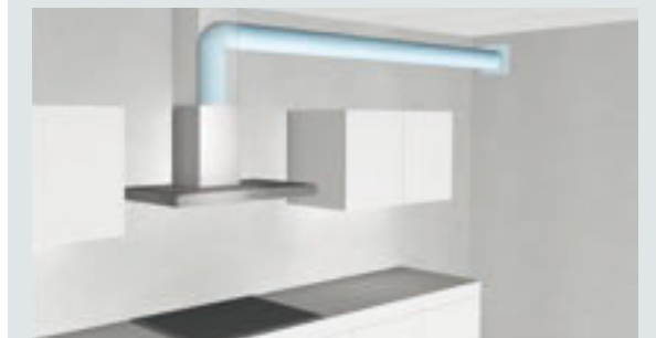
Beispiel einer guten Verrohrung
