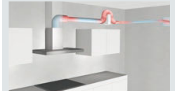
Beispiel einer schlechten Verrohrung
