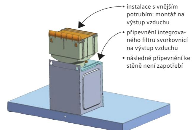
Poznámka: Pro pohodlnou výměnu filtru a optimální výstup vzduchu je zapotřebí ponechat minimální odstup od stropu 25 cm.
