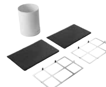
LZ29IDP00 Standard kulfiltersæt Startsæt til brug for recirkulation. Standard kulfilter. Levetid: 12 måneder. Lugtreduktion: > 80 %. Indeholder 2 kulfiltere, fleksslange og 2 monteringsrammer. Vejl. pris kr. 2 072,00
