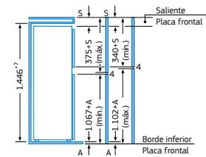
Las dimensiones de la puerta del mueble corresponden a una junta de puerta de 4 mm y un grosor comprendido entre 16 mm y 20 mm. Para grosores distintos, consultar a Balay. Si se utiliza una junta de un ancho diferente (máx. 14 mm) deben adaptarse las medidas.
