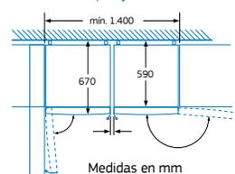
El dibujo incluye el accesorio de unión. Las bandejas y los cajones se pueden extraer completamente incluso cuando el aparato se encuentra colocado directamente junto a la pared. Cambiar apertura de puerta y distanciador lateral del cajón de frutas y verduras para una correcta apertura de puertas y cajones. No está permitido introducir ningún elemento separador entre los aparatos.
