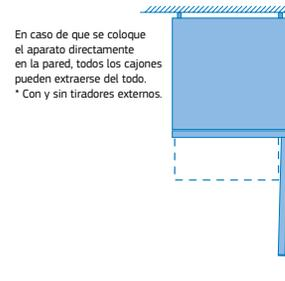
En caso de que se coloque el aparato directamente en la pared, todos los cajones pueden extraerse del todo.
