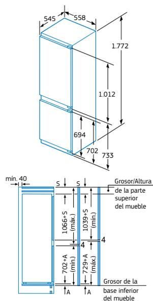
Las dimensiones dadas de la puerta del mueble corresponden a una junta de puerta de 4 mm y un grosor comprendido entre 16 mm y 20 mm. Para grosores distintos, consultar a Balay.
