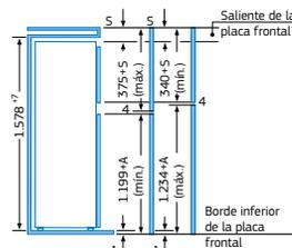
Las dimensiones de la puerta del mueble corresponden a una junta de puerta de 4 mm y un grosor comprendido entre 16 mm y 20 mm. Para grosores distintos, consultar a Balay. Si se utiliza una junta de un ancho diferente (máx. 14 mm) deben adaptarse las medidas.
