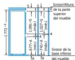
En medidas superiores (1.780-1.790) se debe tener en cuenta el listón distanciador del hueco. Las dimensiones de la puerta del mueble corresponden a una junta de puerta de 4 mm y un grosor comprendido entre 16 mm y 20 mm. Para grosores distintos, consultar a Balay. Si se utiliza una junta de un ancho diferente (máx. 14 mm) las medidas deben adaptarse.
