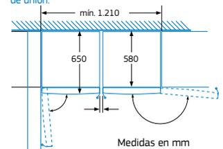
Las bandejas y los cajones se pueden extraer completamente incluso cuando el aparato se encuentra colocado directamente junto a la pared.
