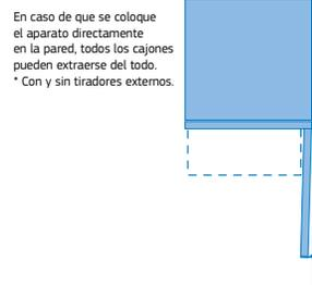
En caso de que se coloque el aparato directamente en la pared, todos los cajones pueden extraerse del todo.
