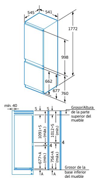
Las dimensiones dadas de la puerta del mueble corresponden a una junta de puerta de 4 mm y un grosor comprendido entre 16 mm y 20 mm. Para grosores distintos, consultar a Balay.
