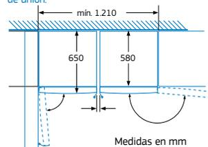
Las bandejas y los cajones se pueden extraer completamente incluso cuando el aparato se encuentra colocado directamente junto a la pared.
