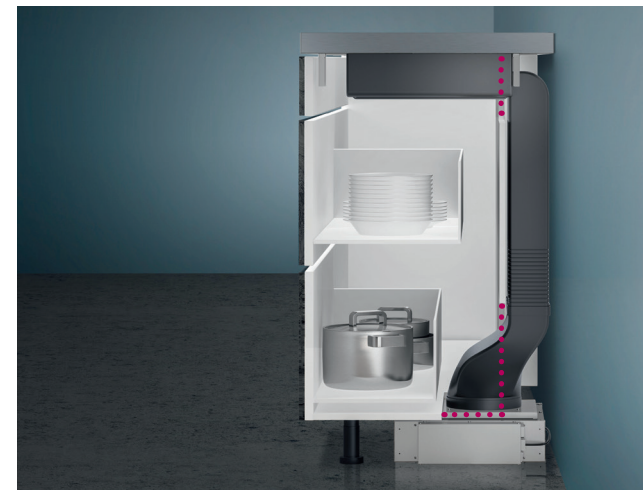
Coupe transversale .....Découpe de la paroi arrière nécessaire
