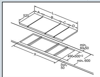
Bei Einbau zweier oder mehrerer Elemente nebeneinander sind ein oder mehrere Montagesätze erforderlich (2 Elemente: 1 Montagesatz, 3 Elemente: 2 Montagesätze usw.).
