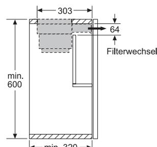
Montage Gerät mit Clean Air Modul
