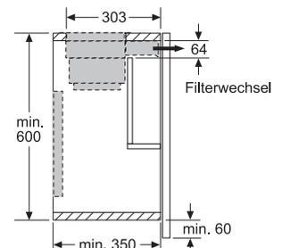
Montage Gerät mit Clean Air Modul und Absenkrahmen
