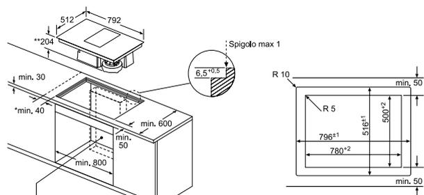
Zona per il modulo a ricircolo o il canale. Posizione precisa a seconda della profondità del piano di lavoro.
