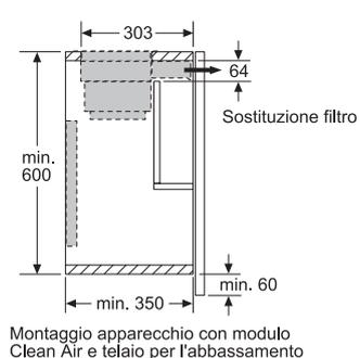
Montaggio apparecchio con modulo Clean Air e telaio per l'abbassamento
