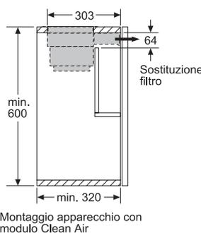
Montaggio apparecchio con modulo Clean Air
