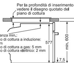
Se l'apparecchio viene montato sotto un piano di cottura deve essere rispettato il seguente spessore del piano di lavoro (event. incl. sottostruttura).
