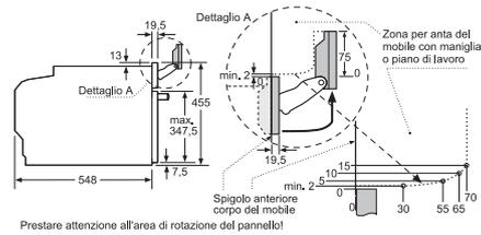
Montaggio con un piano di cottura.
