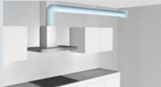
Beispiel einer guten Verrohrung
