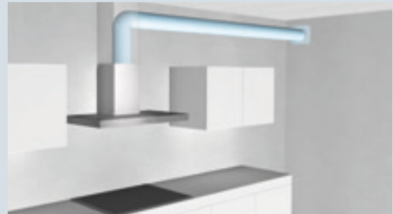
Beispiel einer guten Verrohrung
