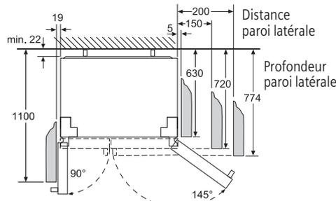
Tiroirs pouvant être entièrement retirés à une ouverture de la porte à 145°.
