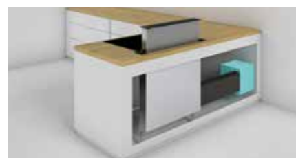
Instalación a pared con motor disociado².
