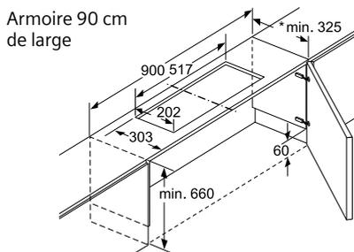
Installation de l'appareil avec module cleanAir et cadre d'abaissement
