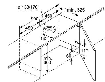
Installation de l'appareil avec cadre d'abaissement
