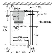
Montage Gerät mit Clean Air Modul und Absenkrahmen
