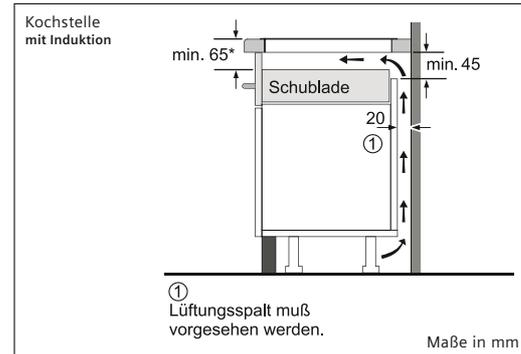
Unterhalb der Induktionskochstelle befindet sich das Kühlgebläse. Sollte die Kochstelle über einer Schublade liegen, so ist der Einsatz eines Zwischenbodens zu empfehlen, da sonst kleine leichte Gegenstände, welche sich in der Schublade befinden, angesaugt werden könnten. Ein Lüftungsspalt zwischen Möbel und Wand muss vorgesehen werden. Ein Entlüftungsspalt zwischen Arbeitsplatte und Möbel-Front ist aber nicht erforderlich.
