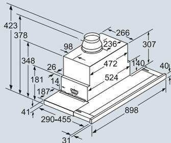
Tiefenanpassung des Filterauszuges bis 29 mm möglich
