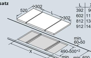
Bei Einbau von zwei Domino-Elementen direkt neben einer Mulde sind zwei Montagesätze (HZ394301) erforderlich.
