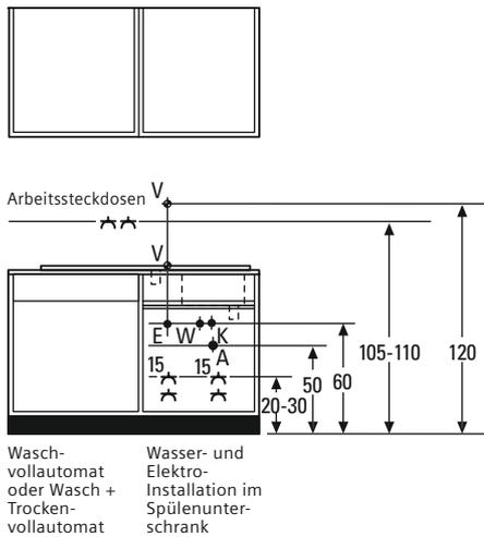
Washvollautomat oder Wasch + Trockenvollautomat
