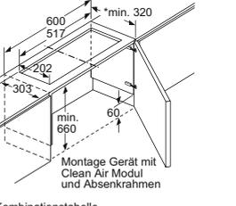
Montage Gerät mit Absenkrahmen Montage direkt an der Küchenwand
