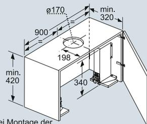
Bei Montage der 90cm Flachschirmhaube in einen 90cm breiten Oberschrank ist ein Montage-Set erforderlich. Die beiden Montagewinkel werden rechts und links im Möbel verschraubt. Montage nach Schablone.
