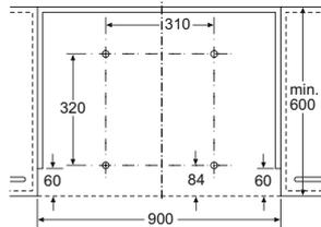
Montage Gerät mit Absenkrahmen
