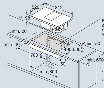
Bereich für das Umluftmodul oder den Kanal.
