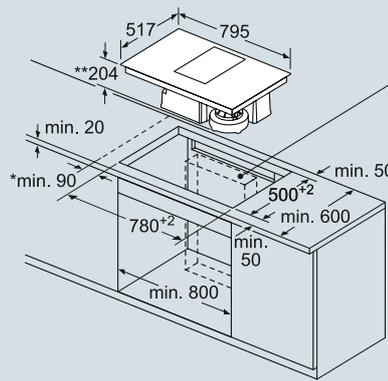
Bereich für das Umluftmodul oder den Kanal.
