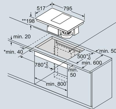
Bereich für das Umluftmodul oder den Kanal.
