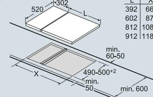
Bei Einbau eines Domino-Elementes direkt neben einer Mulde ist ein Montagesatz (HZ394301) erforderlich.
