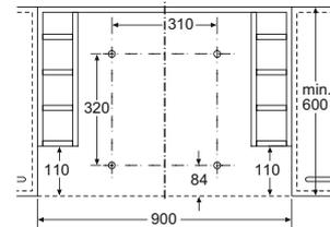
Montage Gerät mit Absenkrahmen
