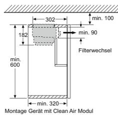
Montage Gerät mit Clean Air Modul
