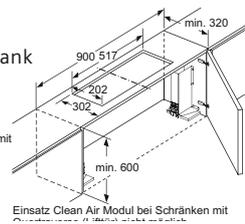
Einsatz Clean Air Modul bei Schränken mit Quertraverse (Lifttür) nicht möglich.
