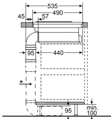
\*Beispielhafte weitergehende Abluftverrohrung mit 220x90 mm Flachkanalsystem. Nicht Bestandteil des Lieferumfangs.
