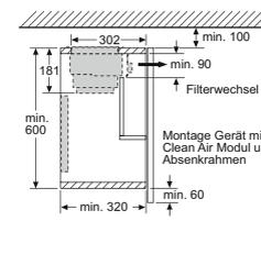
Montage Gerät mit Clean Air Modul und Absenkrahmen
