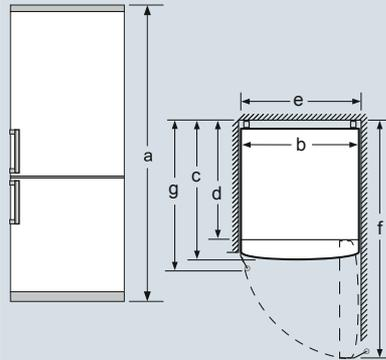
Wird das Gerät direkt an die Wand gestellt, können alle Schubladen vollständig herausgezogen werden.
