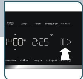
Programm durch Drücken der Taste «» starten. Nach der Beladungserkennung wird Wasser eingelassen und der Waschvorgang startet.
