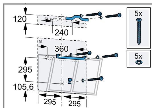
4. Die beiliegenden Schrauben in die obere Geräteaufhängung vollständig eindrehen.
