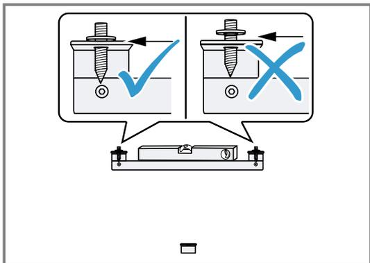
4. Um das Gerät auszurichten, das Gerät bei Bedarf von oben mit einem Schraubendreher in der Höhe justieren.
