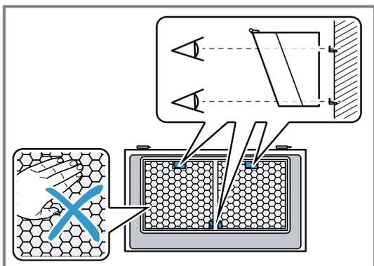
6. **Hinweis:** Die Gasdruckdämpfer nicht gegen den lackierten Innenrahmen schlagen. Die Gasdruckdämpfer links und rechts am Gerät einklipsen.
