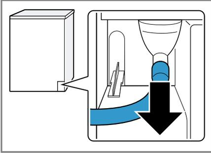
Der Kondenswasserschlauch ist werkseitig am Stutzen angeschlossen.
