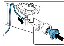
Die Anschlussstelle mit einer Schlauchschelle (12-22 mm) sichern.
