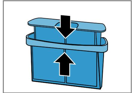
8. Das zweiteilige Flusensieb einsetzen.
