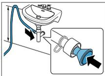
Asegurar el punto de conexión con una abrazadera (12-22 mm). Fijar la manguera de desagüe con un tubo guía a una altura mínima de 80 cm y máxima de 100 cm.
