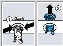
5. Unter fließendem Wasser die Siebelemente reinigen.
