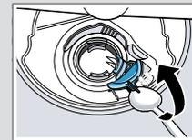
5. Die Pumpenabdeckung schräg nach innen anheben und entfernen.
