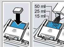
2. Den Deckel der Reinigerkammer schließen.
