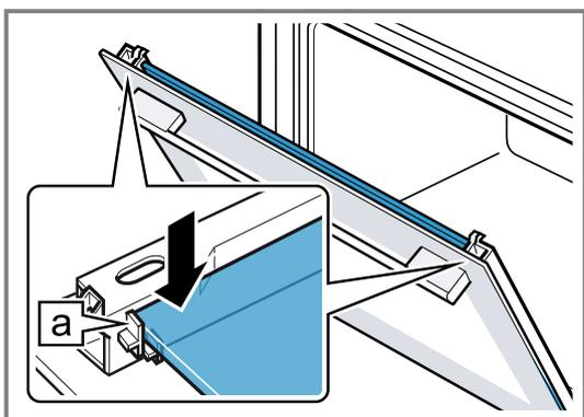
5. Die Gerätetür öffnen und Türdichtung einhängen.
