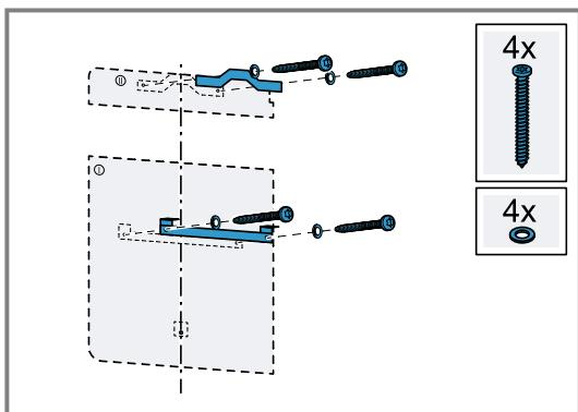
4. Avvitare completamente le viti in dotazione nella sospensione superiore dell'apparecchio.
