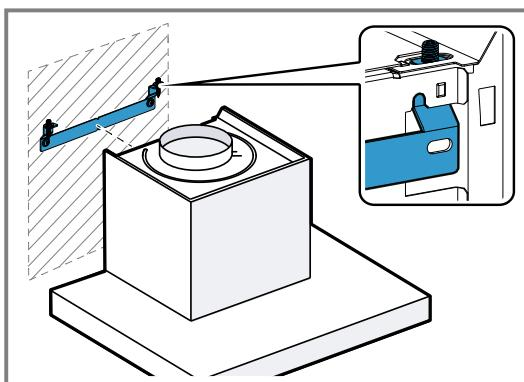
3. Se necessario, per allineare l'apparecchio, dalla parte superiore regolare in altezza l'apparecchio servendosi di un cacciavite.
