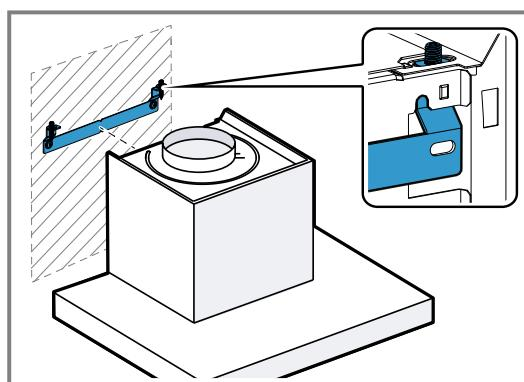
3. Pour aligner l'appareil, ajuster si nécessaire la hauteur de l'appareil par le haut à l'aide d'un tournevis.
