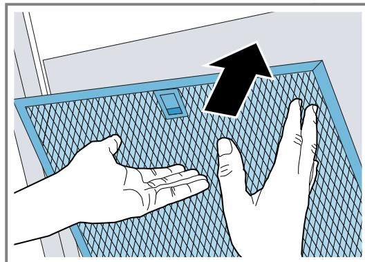
3. S'assurer que les dispositifs de verrouillage s'encliquettent.
