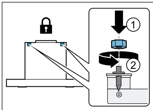
**5. Visser la vis de blocage à l'aide d'un tournevis**
