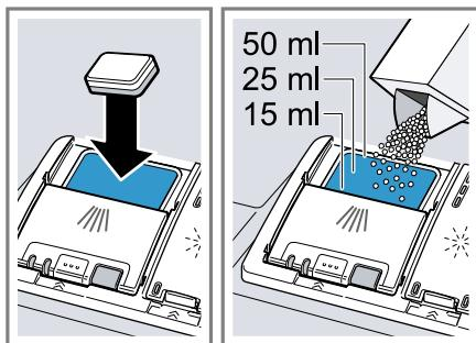
Wenn Sie Tabs verwenden, genügt eine Tablette. Tabs quer einlegen. Wenn Sie Pulverreiniger oder Flüssigreiniger verwenden, beachten Sie die Dosierungshinweise des Herstellers und die Dosierungseinteilung der Reinigerkammer. Bei normaler Verschmutzung genügen 20 ml – 25 ml Reiniger. Bei wenig verschmutztem Geschirr genügt eine etwas geringere als die angegebene Reinermenge.
