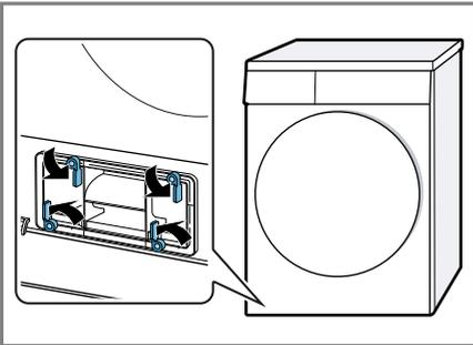
3. Die Wärmetauscherabdeckung am Griff herausziehen.
