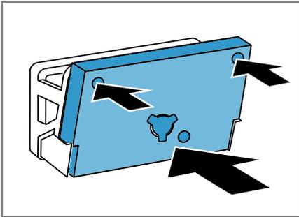
Stellen Sie sicher, die gereinigte Filtermatte nicht zu verformen, zu beschädigen oder seitenverkehrt auf die Halterungen zu schieben.
