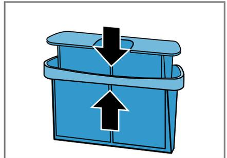
10. Das zweiteilige Flusensieb einsetzen.
