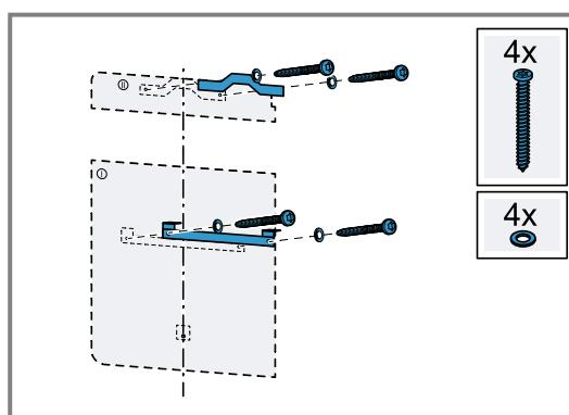
4. Die beiliegenden Schrauben in die obere Geräteaufhängung vollständig eindrehen.
